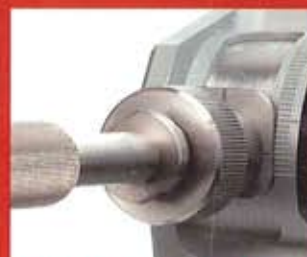
Excenterskive tredobler udnyttelsen af diamant- skiven.
