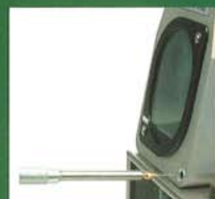
Præcis længdebestemmelse af elektrodens stick-out.
